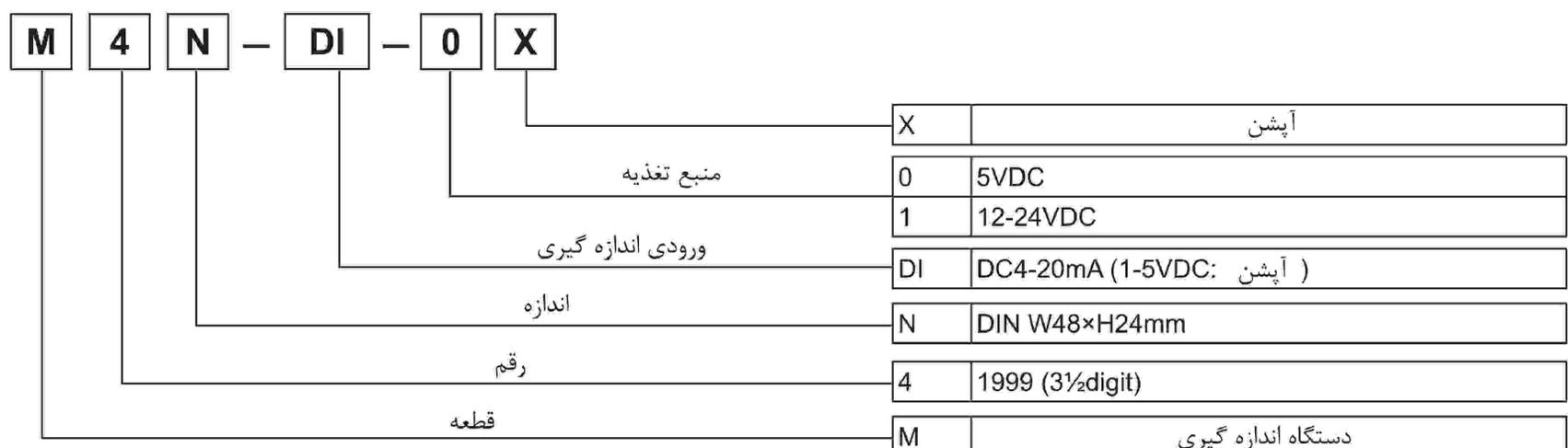
\* ورودی اندازه گیری 1-5VDC به صورت آپشن است.
