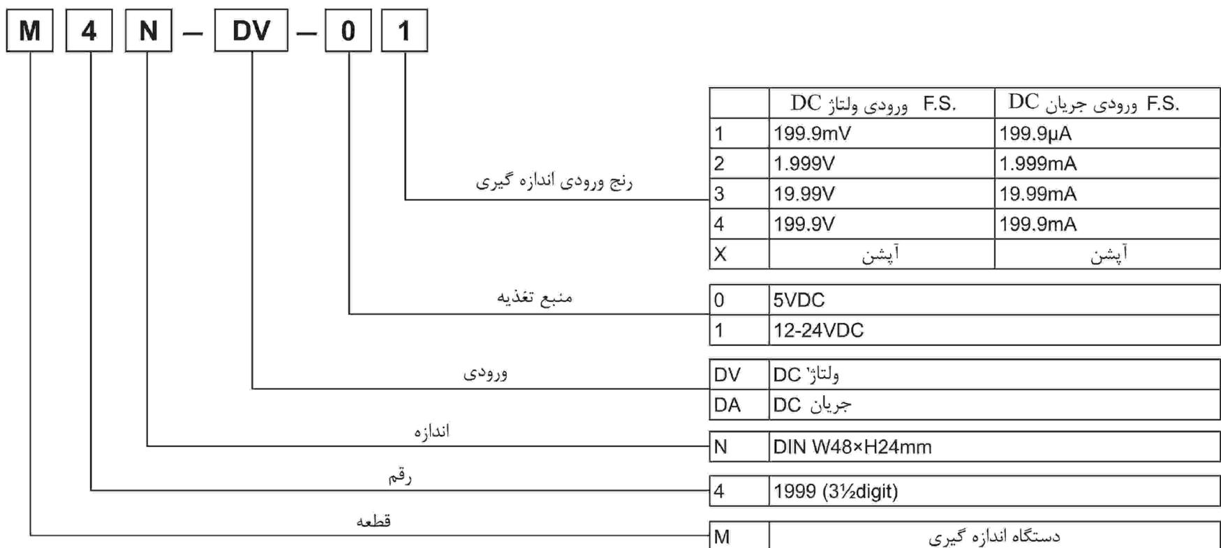
\* سری M4N فقط برای اندازه گیری DC می باشد. اندازه گیری ولتاژ و جریان AC در دسترس نمی باشد.
