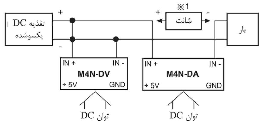
(\*) اگر جریان اندازه گیری بیش از رنج ورودی اندازه گیری بود، از شانت استفاده کنید. اگر ولتاژ اندازه گیری بیش از رنج ورودی اندازه گیری بود از مالتی پلیمر استفاده کنید.
