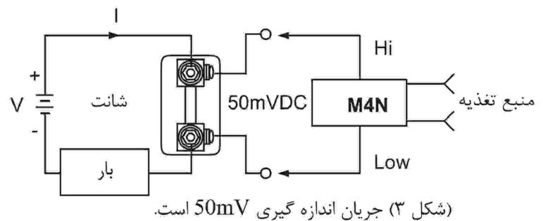
\* در صورتی که رنج اندازه‌گیری ولتاژ بیش از 200VDC بود، لطفاً با استفاده از مالتی‌پلیر مقدار R1, R2 را به گونه‌ای انتخاب کنید که V2 کمتر از حداکثر ولتاژ اندازه‌گیری شود.
