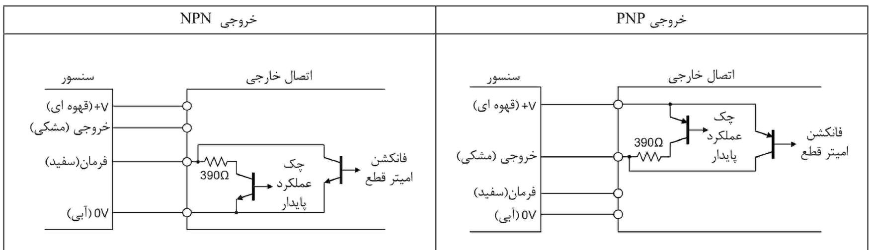
\* در صورت استفاده همزمان از فانکشن چک پایداری عملکرد و امیتر قطع، ترانزیستور مورد استفاده باید توانایی قطع و وصل ۱۰ ولت/۵۰ میلی آمپر و بار مقاومتی ۱/۸ وات را داشته باشد. در صورت خطا ممکن است باعث آسیب به دستگاه شود.
