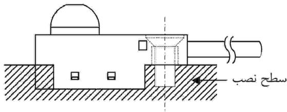
۲- نصب روی سطح تراز یک اسپیسر بین سطح نصب و قسمت مخصوص نصب سنسور مطابق شکل قرار دهید.
