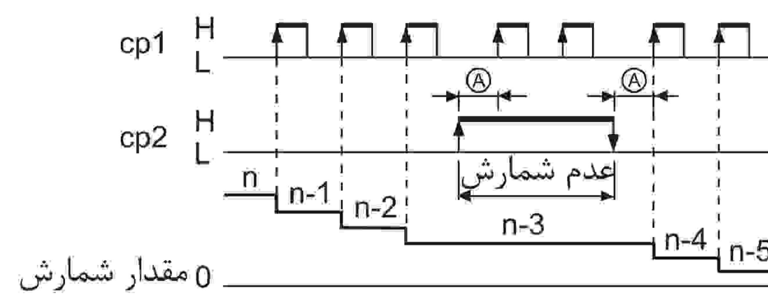
در حالت مد ورودی شمارش صعودی، حتی اگر نوع خروجی سنسور با نوع ورودی شمارنده هماهنگ نباشد، باز هم شمارش فعال است. (مثلثاً ورودی ولتاژ شمارنده به خروجی سنسور از نوع NPN متصل شود).
