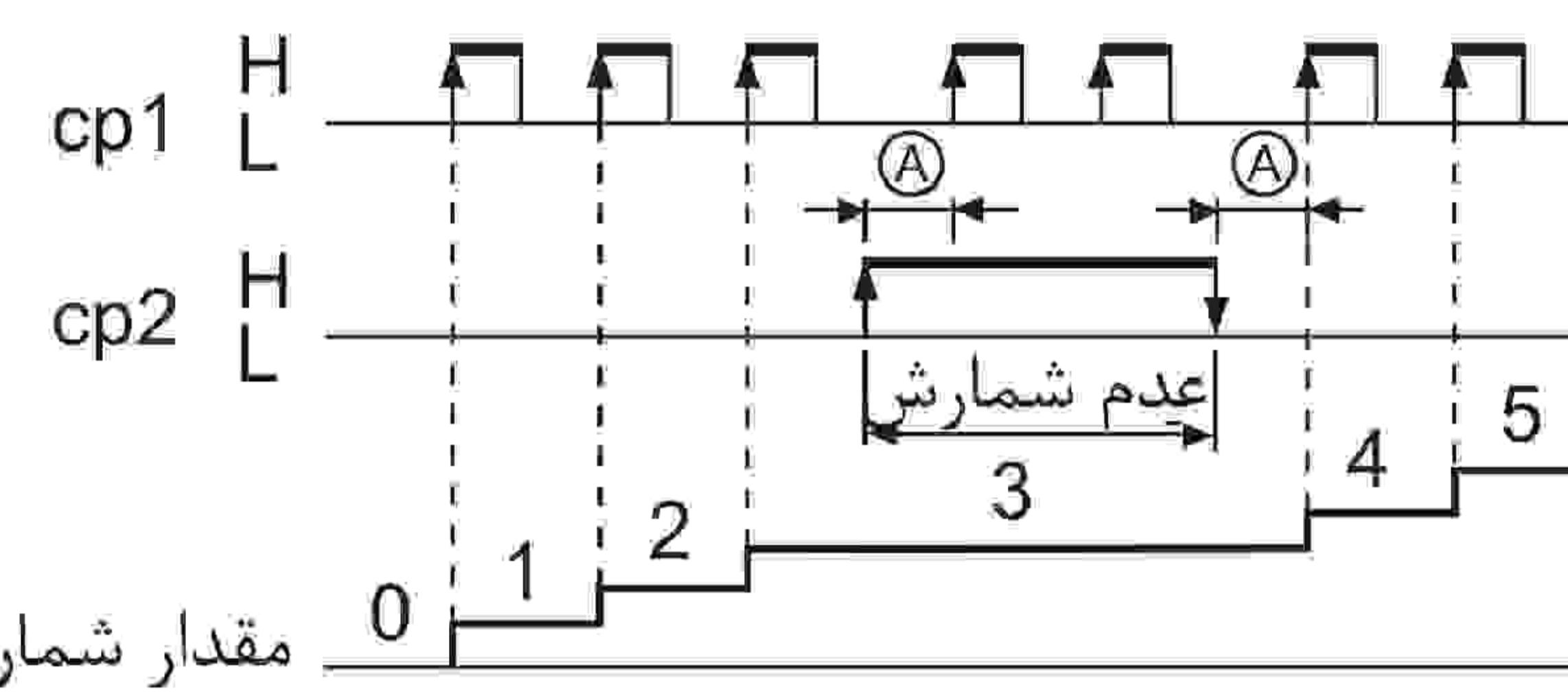
در حالت مد ورودی شمارش صعودی، حتی اگر نوع خروجی سنسور با نوع ورودی شمارنده هماهنگ نباشد، باز هم شمارش فعال است. (مثلثاً ورودی ولتاژ شمارنده به خروجی سنسور از نوع NPN متصل شود).
