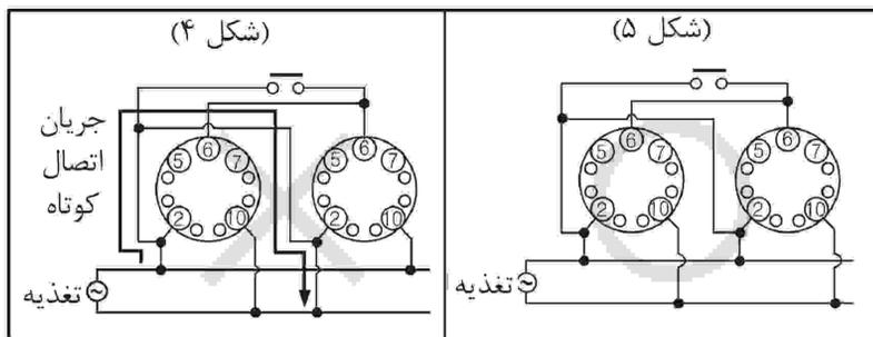
\* سیگنال های INHIBIT، شروع و ریست برای اتصال کوتاه کردن ترمینالهای ۲-۵، ۲-۶، ۲-۷، اعمال می شود. در صورت اتصال به ترمینال دیگر یا اعمال ولتاژ بالا مدار داخلی آسیب خواهد دید.
