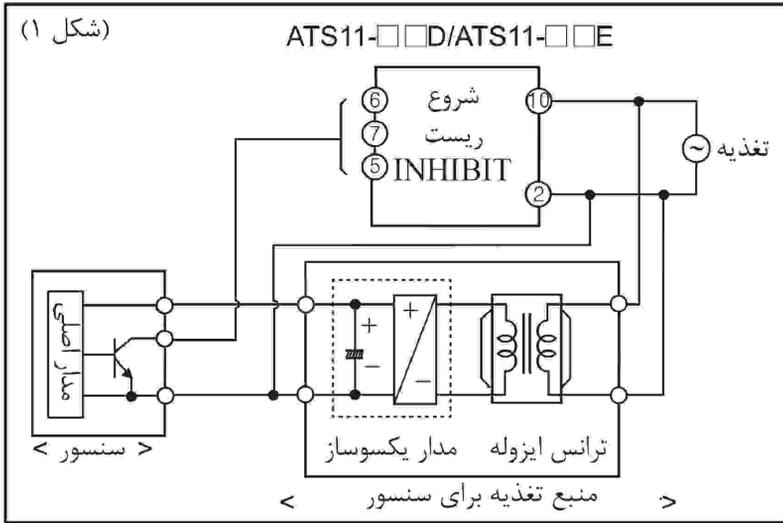
\* مانند شکل ۲ در صورت استفاده از ترمینال ۱۰ به عنوان ترمینال مشترک سیگنال ورودی، ممکن است باعث آسیب به مدار داخلی ATS11--D/ATS11--E شود. با توجه به شکل ۳ از ترمینال ۲ به عنوان ترمینال مشترک استفاده کنید.
