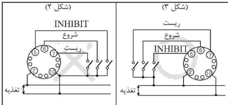
\* در صورت کنترل چندین تایمر با یک کنتاکت ورودی یا ترانزیستور، آنرا مانند شکل ۴ سیم بندی نکنید. این مدل سیم بندی باعث تولید جریان کمی به دلیل عدم توالی فاز تغذیه می شود. مانند شکل ۵ سیم بندی کنید.
